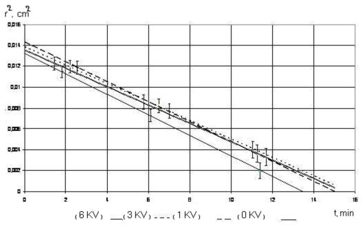
شكل 3 : آلية تغير قيمة مساحة سطح قطرات الماء المقطر عند 40°C في الحقل الكهربائي الساكن
