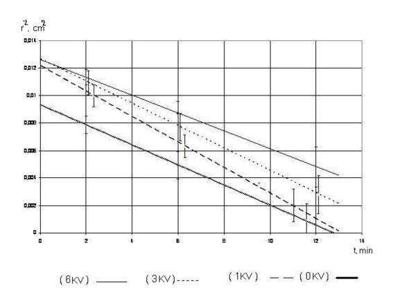
شكل 4 : آلية تغير مقدار مساحة سطح قطرات محلول Nacl بتركيز % 15 عند درجة الحرارة 40°C في الحقل الكهربائي الساكن .
