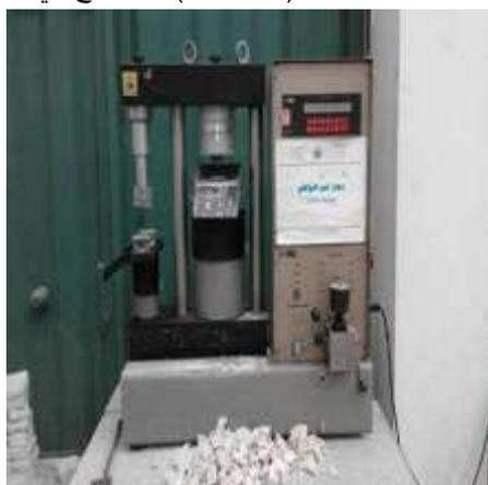
الشكل (2) جهاز قياس مقاومة الانحناء
