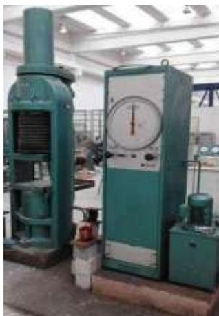
الشكل (1) جهاز قياس مقاومة الانضغاط
