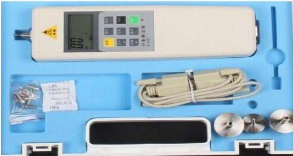
الشكل (3) جهاز قياس قوة الهلام من النوع Penetrometer موديل G4
