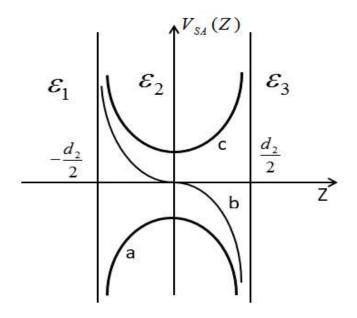
الشكل2: طاقة الكمون الذاتي كتابع للإحداثية z في ثلاث حالات لمعاملات العازلية الكهربائية  ${\cal E}_2 >> {\cal E}_{1,3}$  (c  ${\cal E}_1 < {\cal E}_2 < {\cal E}_3$  (b  ${\cal E}_2 << {\cal E}_3$  (a
