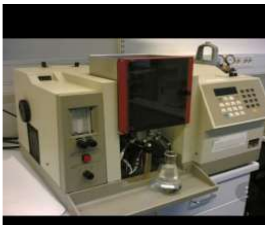
الشكل (2): جهاز الامتصاص الذري (Atomic Absorption Spectrophotometer: AAS) موديل Varian 220
