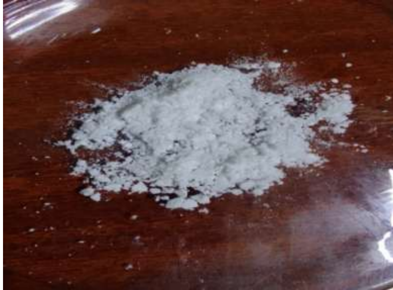
الشكل 2: ملح كبريتات المغنيزيوم الناتجة (g) وفق الطريقة التقليدية
