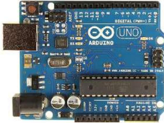
الشكل (4) لوحة التطوير (Arduino Uno).
