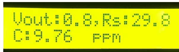
الشكل (15) تركيز الغاز ومقاومة الحساس وجهد مخرجه على شاشة الإظهار LCD
