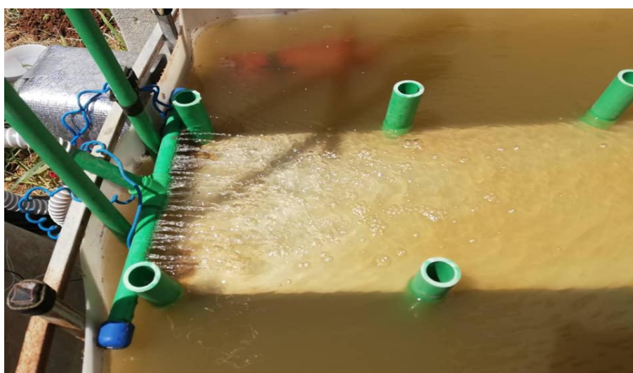
الشكل (3) نمط التهوية السطحية الثاني المستخدم في خلية الوقود الميكروبية لطبقة الرواسب
