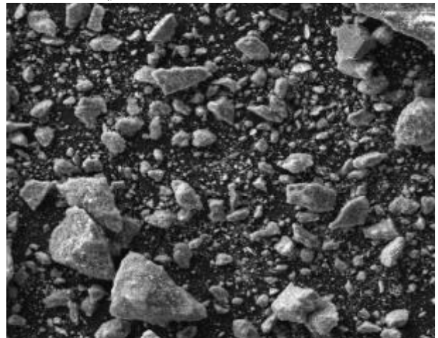
الشكل (3): صور المجهر الإلكتروني الماسح لعينة التراب الدياتومي السوري بمقياس (50 – 200) مايكرومتر
