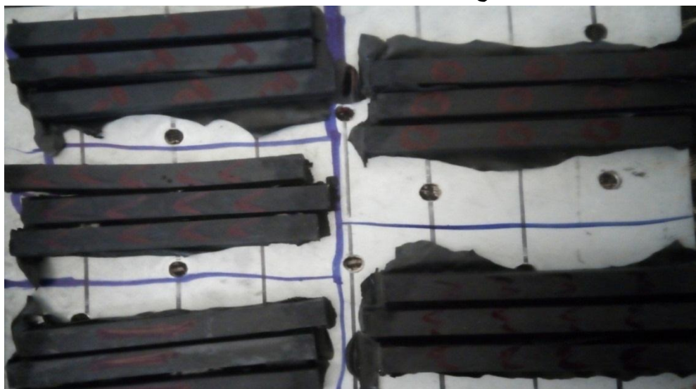
الشكل (7): خمس عينات من خمس خلطات الأولى مع MPT والثانية مع ZDEC والثالثة مع DPG والرابعة مع MPT+ZDEC والخامسة مع MPT+DPG أبعادها طول 106.6 mm وعرض 9.7 mm وسماكة 9.9 mm. تم تحليل خمس خلطات مطاطية هي: MPT, DPG, ZDEC, MPT+DPG, MPT+ZDEC وقد أظهرت النتائج فروقاً واضحة في الخواص الميكانيكية تبعاً لنوع المسرع.
