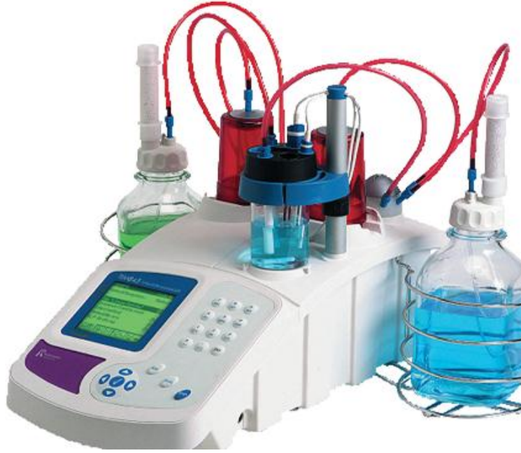
الشكل (1). جهاز المعايرة الكمونية الآلية (الجهاز الفعلي المستخدم في المخبر)
