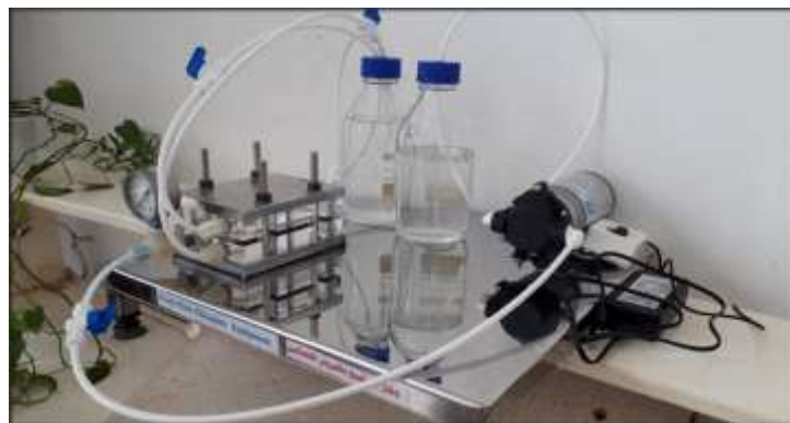
الشكل (4): صورة جهاز الترشيح يعمل بطريقتي التدفق المتقاطع والنهائية المسدودة
